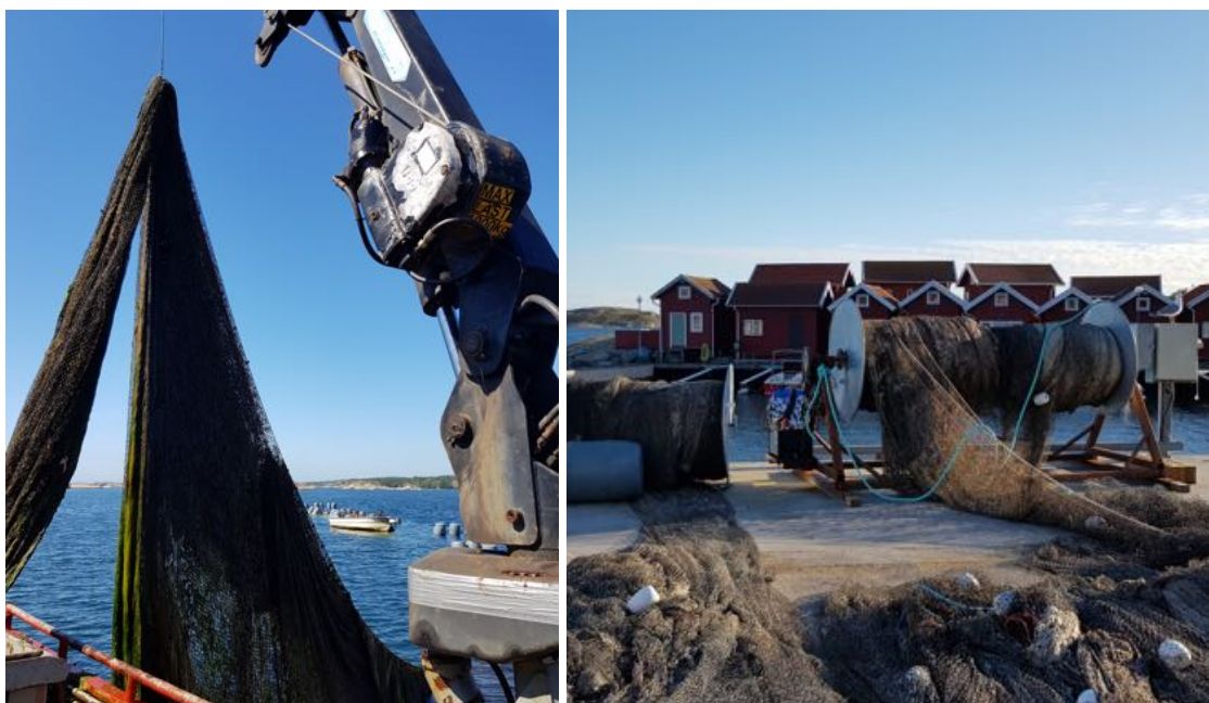
Figur 22. Kran och nätrullar som används för bärgning och hantering av de tunga näten (Foto: Anders Granhed)
